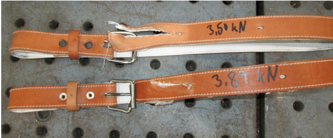
Figur 3. Brott i remmen vid spännets låsning.
