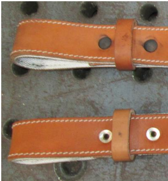
Figur 1. Provföremål med olika typer av nitar.
