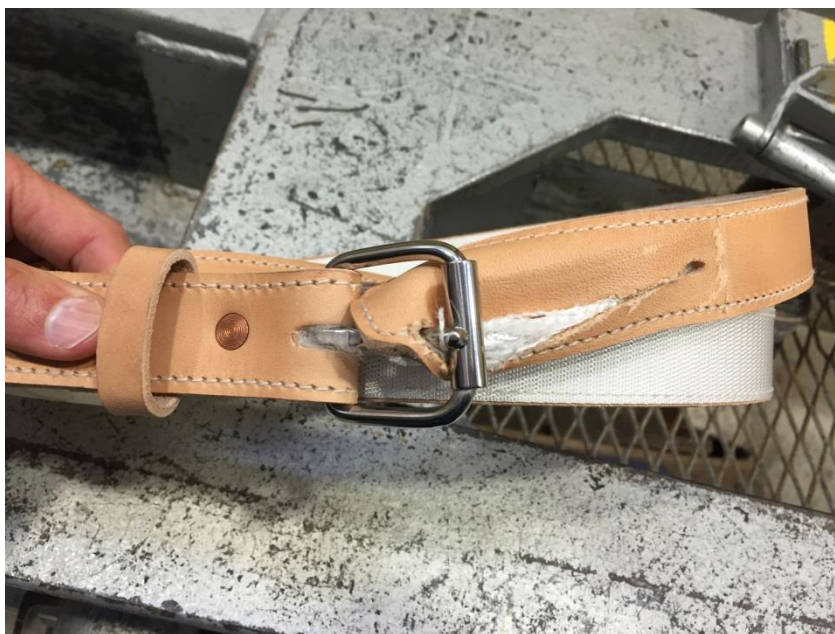
Bild 3. Brott vid dragprov av rem
